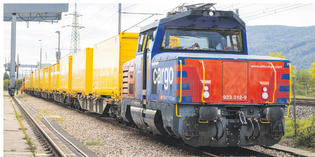
Esercizio di prova con un treno navetta fisso della Posta - con locomotiva ibrida Eem 923 in testa e in coda e agganci automatici - tra i centri pacchi di Dailens, Härkingen e Frauenfeld.
